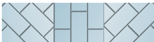
Figure 25: caniveau réalisé par 3 pavés adjacents.
