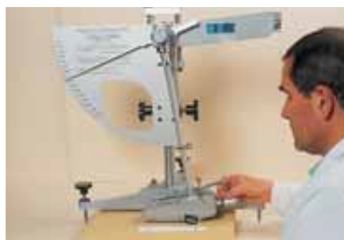
Essai SRT : pendule « Skid Resistance Test ».
